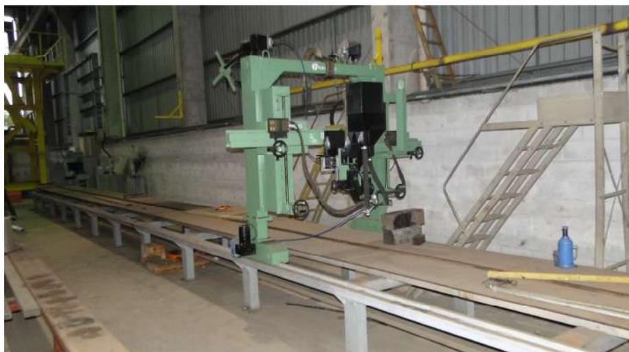
Foto 04: Máquina de arco Submerso para soldagem de vigas (item 203/204)
